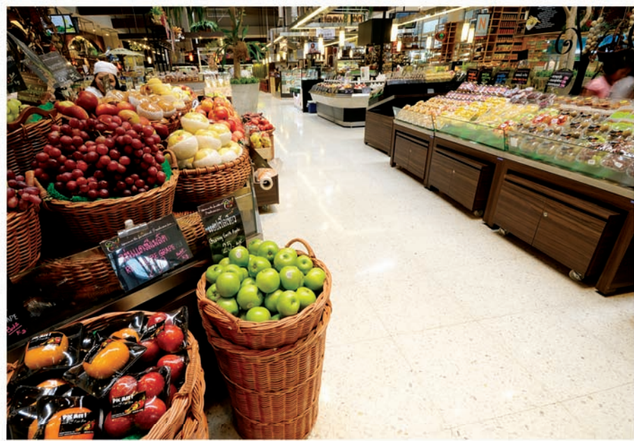
พื้นที่ทั้งหมดภายในกูร์เมต์มาร์เก็ตจะใช้แผ่นเทอร์ราซโซสำเร็จรูป ตราช้าง ขนาด 50 ซม. x 50 ซม. ที่สั่งทำขึ้นเป็นพิเศษ ให้ความรู้สึกโปร่งโล่ง สะอาด และทำให้สินค้าดูโดดเด่น
