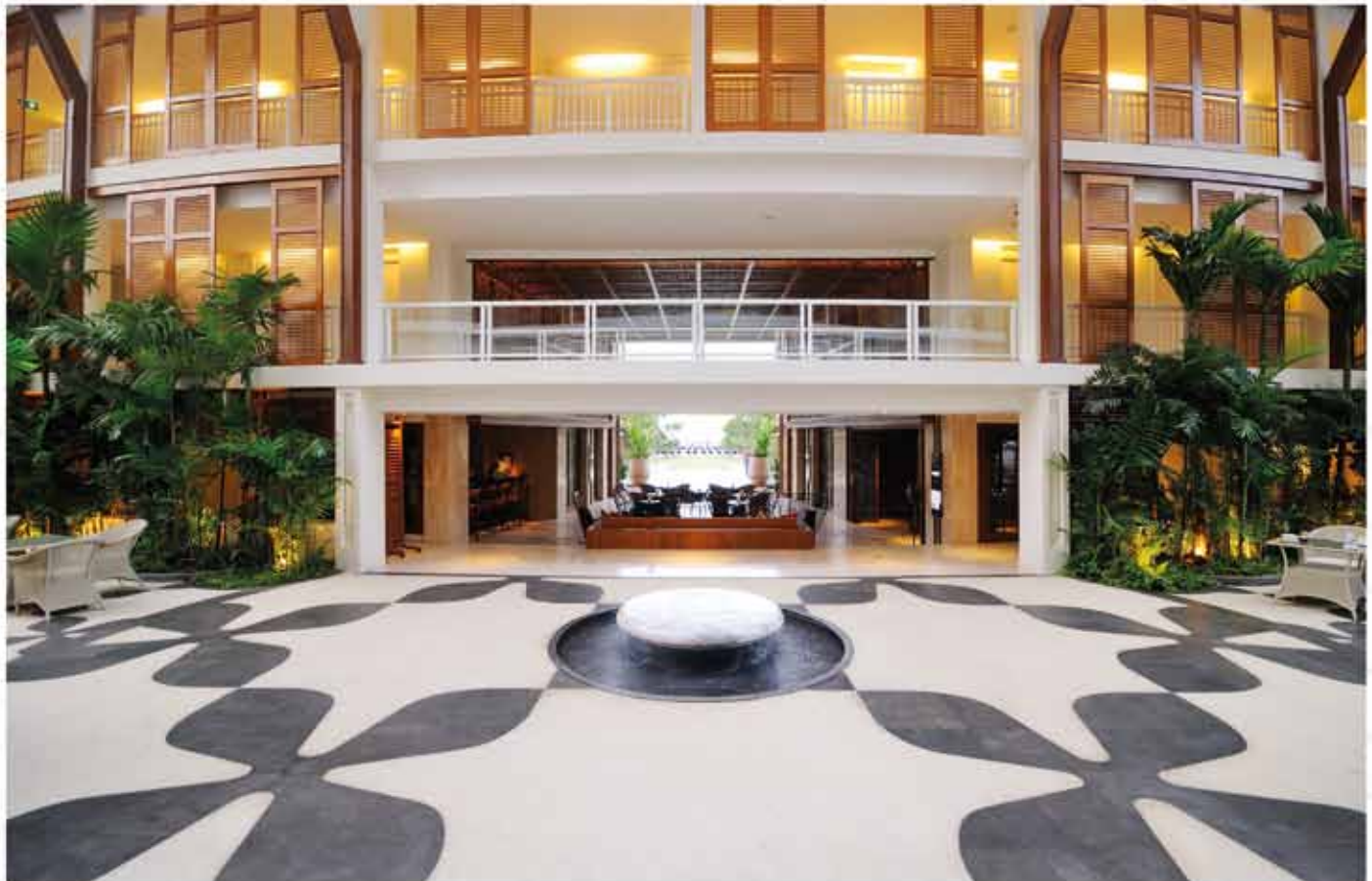
ลวดลายบนพื้นกรวดล้างเชื่อมโยงต่อเนื่องจากภายในสู่ภายนอก
